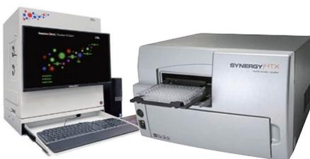
Enzyme-Linked Immunosorbent Assay(ELISA)는 효소결합 면역흡착 분석법으로 항원-항체 결합과 그에 따른 효소반응을 통해 target 물질을 정량화하는 분석법입니다. 주로 96-well plate에 흡착된 capture antibody를 활용해 target 항원의 양을 측정합니다.
